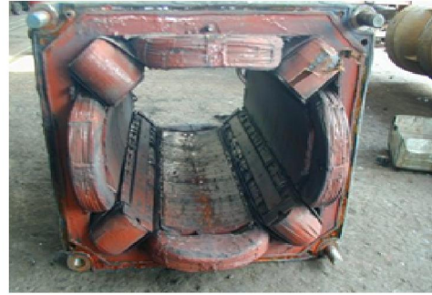
Hình 11: Sơ đồ cấu tạo máy phát điện một chiều
